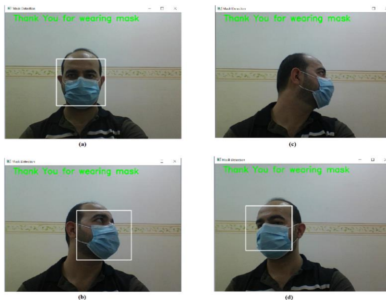
Figure 7. Effect of angle on detection (a) 0°, (b) 45°, (c) 90°, and (d) -45°.
